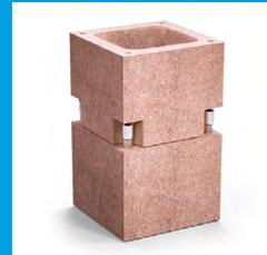
1. Nach dem Herausdrehen der Versetzschaufen werden die vier mitgelieferten Verbindungshülsen in die Gewindehülsen des bereits versetzten Schornsteinelements eingeschraubt.
