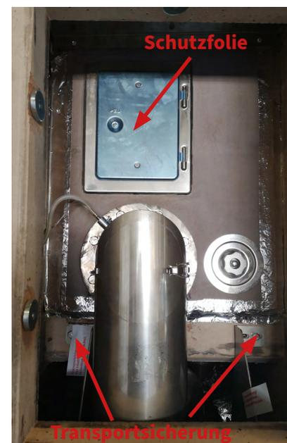
(10) Transportsicherung lösen. Es genügt die Verschraubung an der Betonplatte vollständig zu entfernen. Ansonsten kann es zu Spannungsrissen beim Heizvorgang kommen
